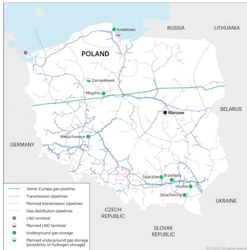
FIG. 10.3 - L'INFRASTRUTTURA DEL GAS POLACCA
