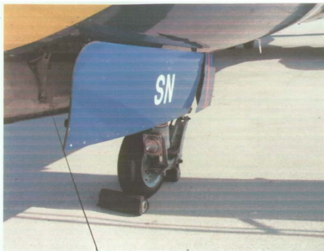
B737 EI-CSN al parcheggio. Notare l'assenza della ruota sinistra del carrello anteriore.
