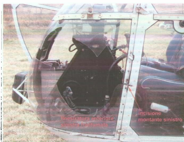
Parte anteriore sinistra elicottero danneggiata dalla collisione contro un cavo metallico.
