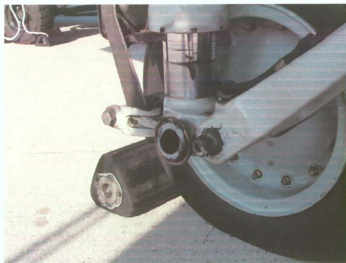
Particolare assale del ruotino anteriore B737.
