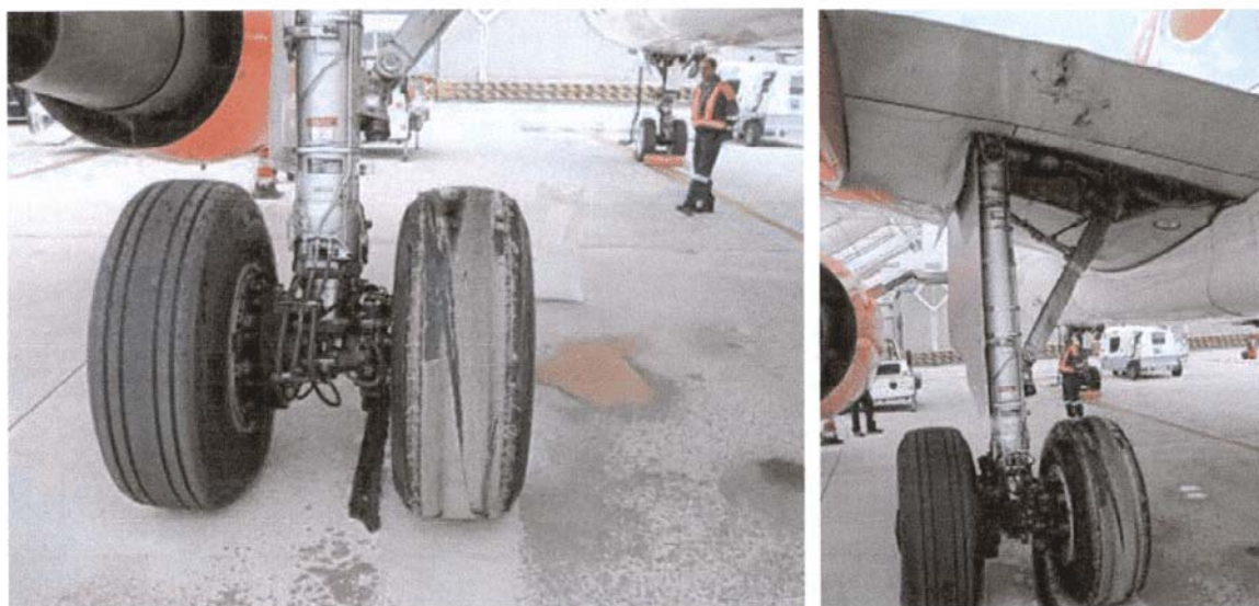
G-EZBO: pneumatico danneggiato (si notino i danni al flap della semiala sinistra).
