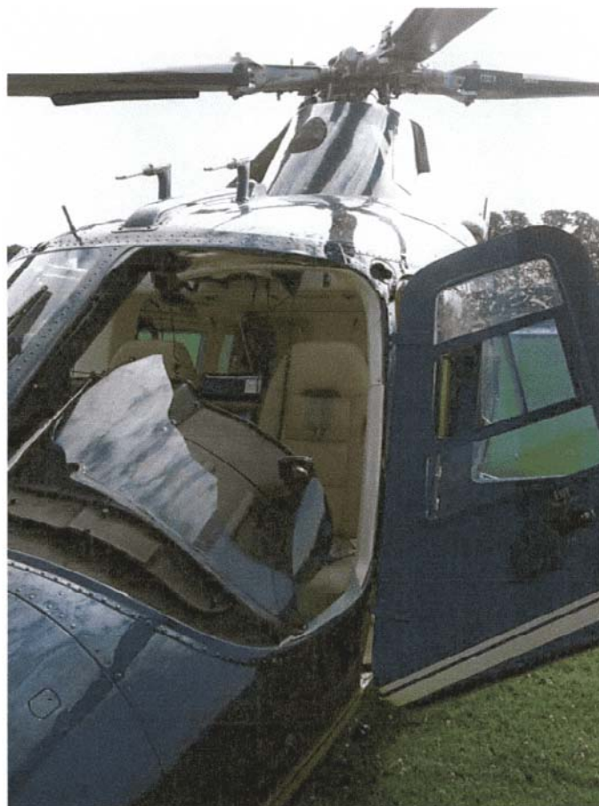
Danni da impatto volatile sull'A109 marche N109TK.
