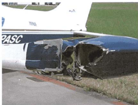
Danni riportati dall'aeromobile PA-28 marche I-PASC a seguito della collisione con un mezzo push back .
