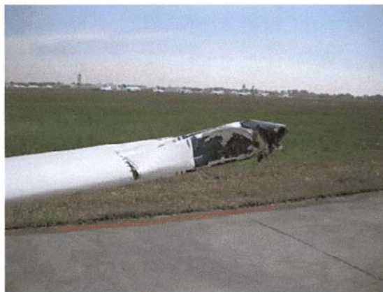
Danni riportati dall'aeromobile PA-28 marche I-PASC a seguito della collisione con un mezzo push back .
