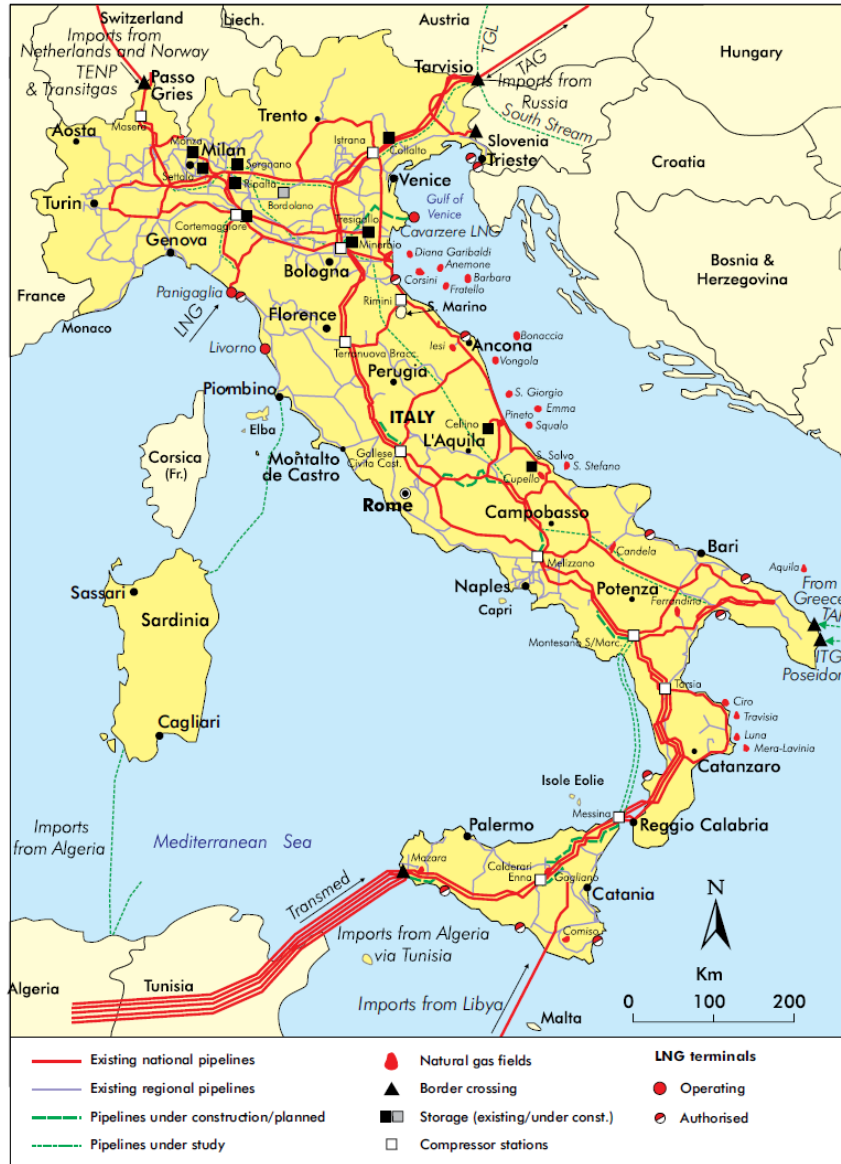
FIG. 13 - SISTEMA INFRASTRUTTURALE DEL GAS IN ITALIA
