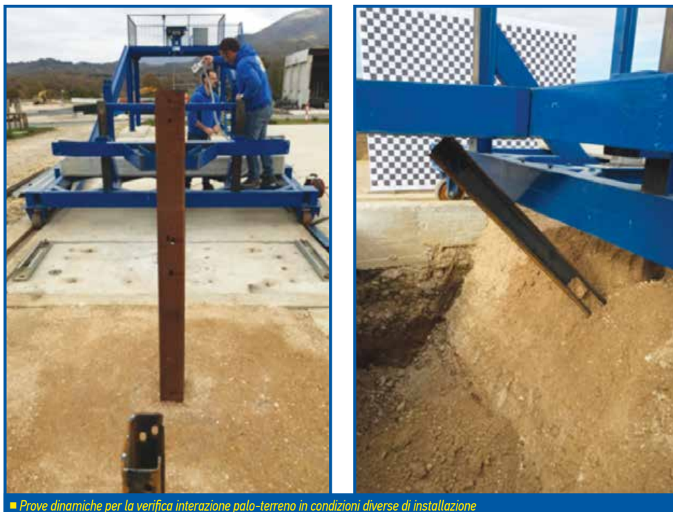
■ Prove dinamiche per la verifica interazione palo-terreno in condizioni diverse di installazione
