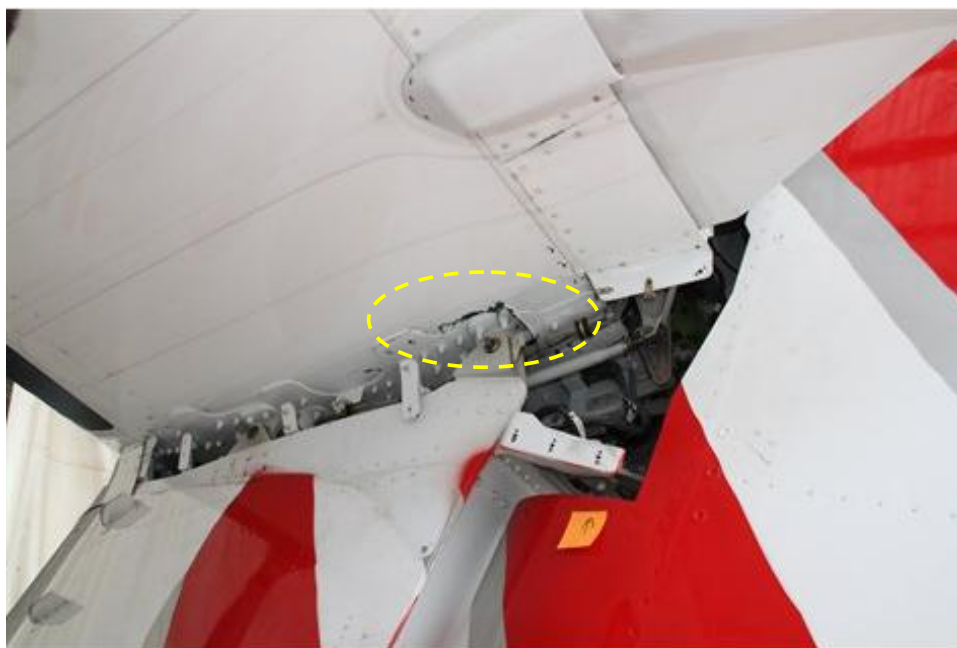
Parte dei danneggiamenti strutturali riscontrati sul VH-FVR.
