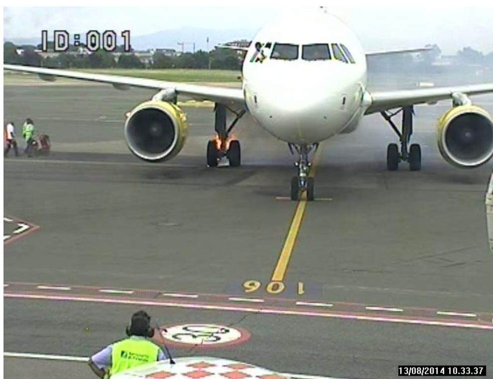
A319 marche EC-JVE: il momento dell'innesco delle fiamme sul carrello principale lato destro.
