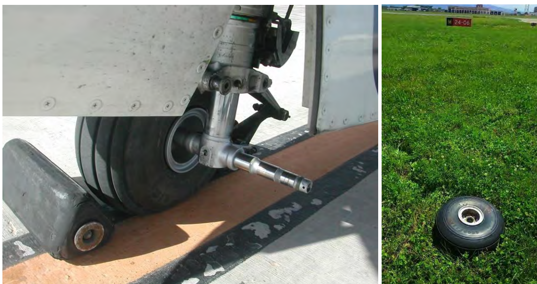
Primo piano del carrello anteriore e posizione di rinvenimento della ruota mancante.
