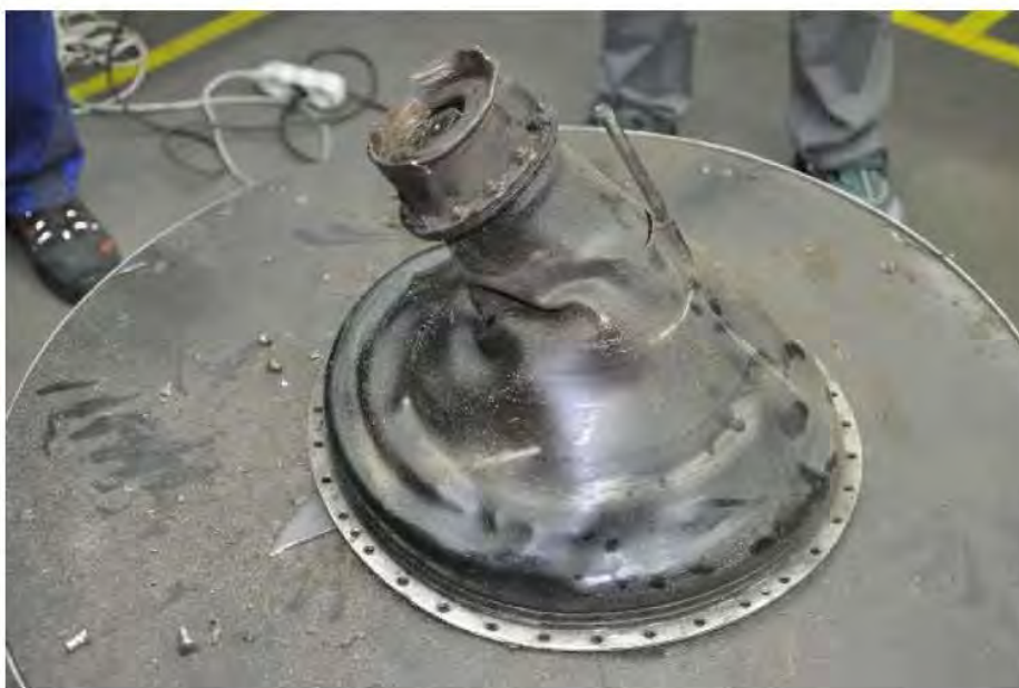
Foto 6: supporting cone con deformazione causata dall'impatto.
