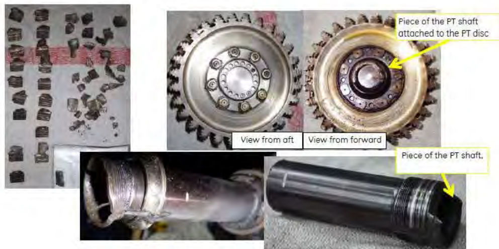
Foto 7: power turbine e frammenti di palette rilasciate in seguito all' overspeed causata dalla rottura dell'albero. Particolari del PT shaft .
