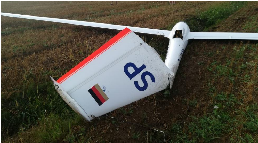
Esempio di atterraggio fuori campo con danni strutturali all'aliante.
