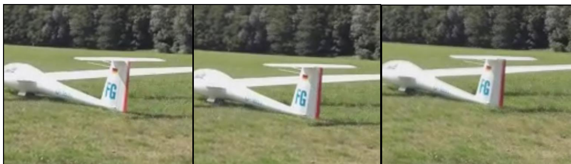
Ricostruzione della deflessione nel tempo del rudder di un aliante mediante l'analisi dei singoli frame .
