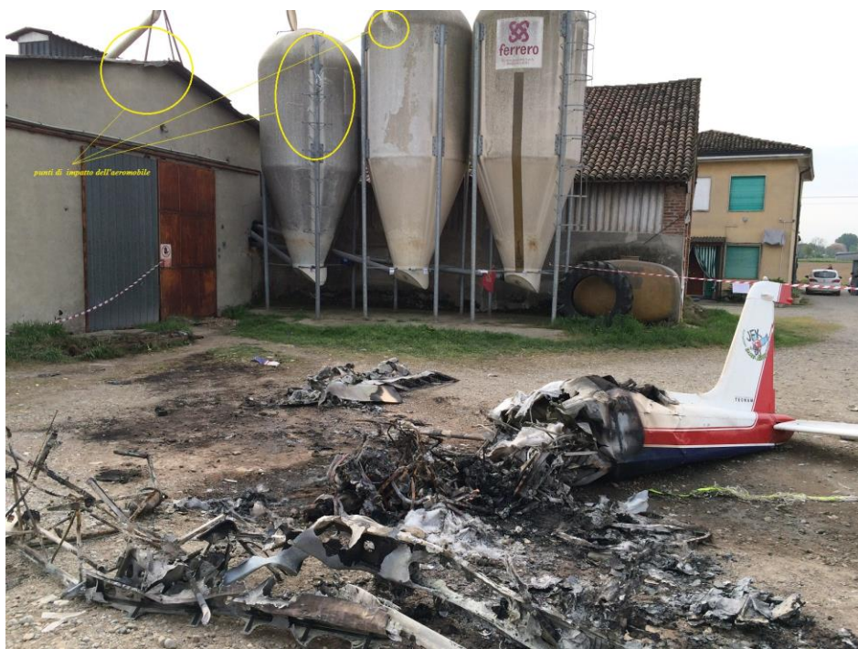
L'aeromobile I-7020 sul luogo dell'incidente e segni di impatto sulle strutture adiacenti.
