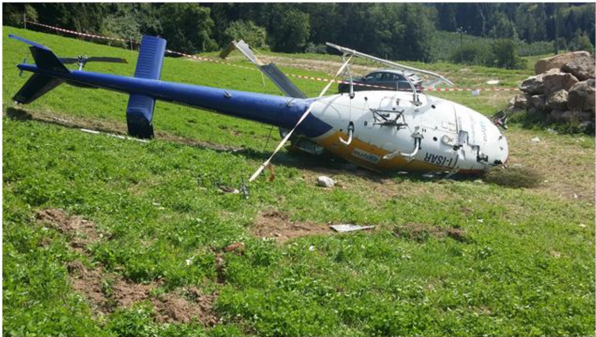
L'AS350 B2 al suolo dopo l'impatto contro l'elettrodotto.
