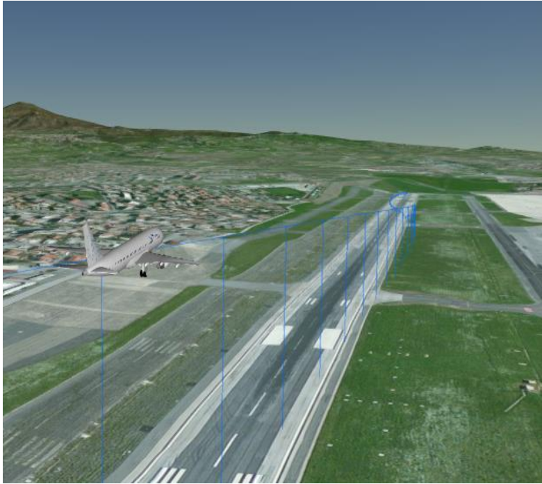
Rappresentazione grafica 3D prodotta mediante parametri FDR.
