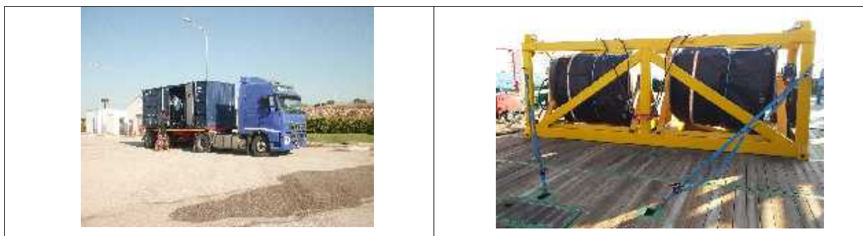
Figura 9 – Container materiale e skid panne oceaniche
