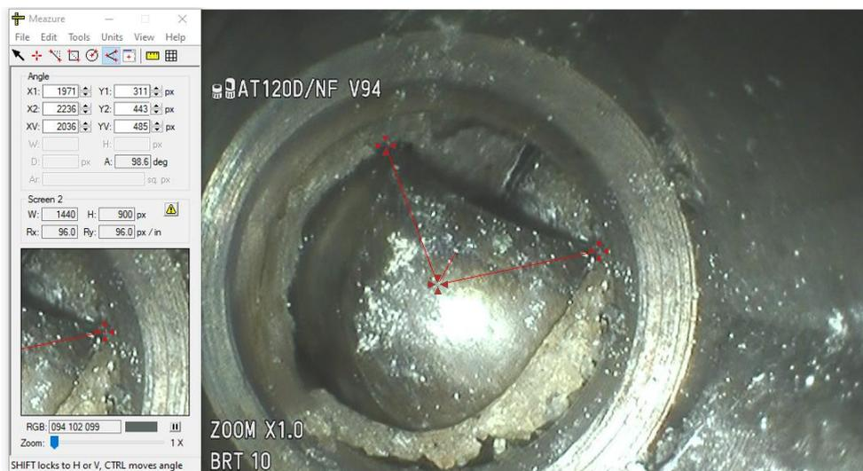
**Misurazioni geometriche su immagine catturata mediante video-endoscopia durante una analisi condotta dai laboratori ANSV.**
