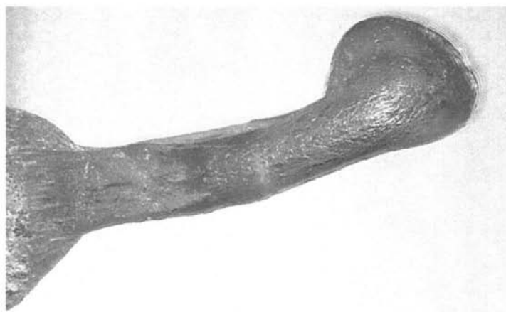
AW109E: forma del bulbo modificata dalle alte temperature raggiunte nel post impatto.
