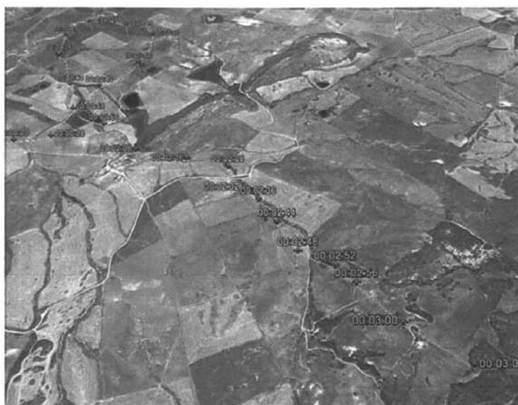
Ricostruzione flight path in presenza di dati GPS ricavati da FDR in maniera parziale.
