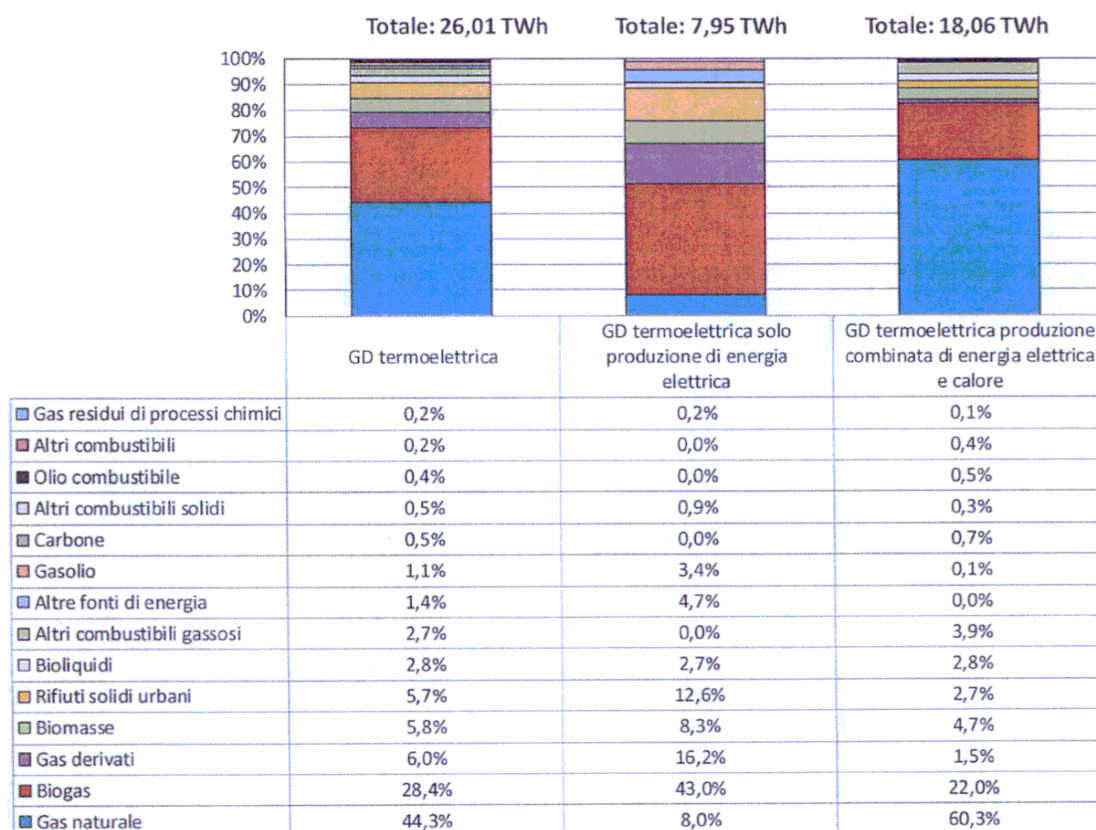
Figura 2.19 14 : Produzione lorda di energia elettrica dalle diverse fonti utilizzate nell'ambito della GD termoelettrica
