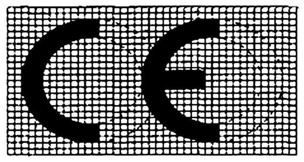
La marcatura CE deve avere un'altezza di almeno 5 mm. Se le dimensioni della marcatura CE sono ridotte o ingrandite, vanno rispettate le proporzioni del disegno in scala graduata sopra presentato.
