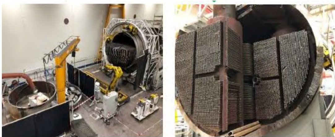
Figura 5: taglio del primo generatore di vapore in officina a secco
